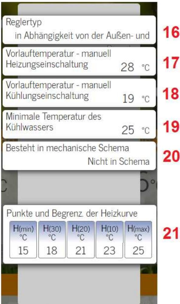
Abbildung 6: Erweitertes Fenster des Direktkreises 2/2
