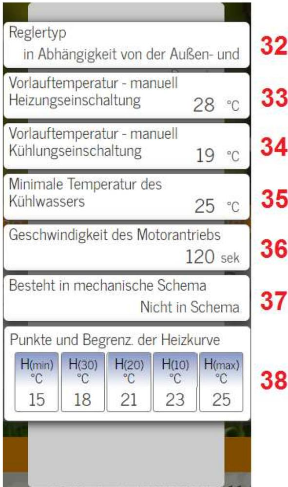
Abbildung 9: Erweitertes Fenster des Mischkreises 2/2
