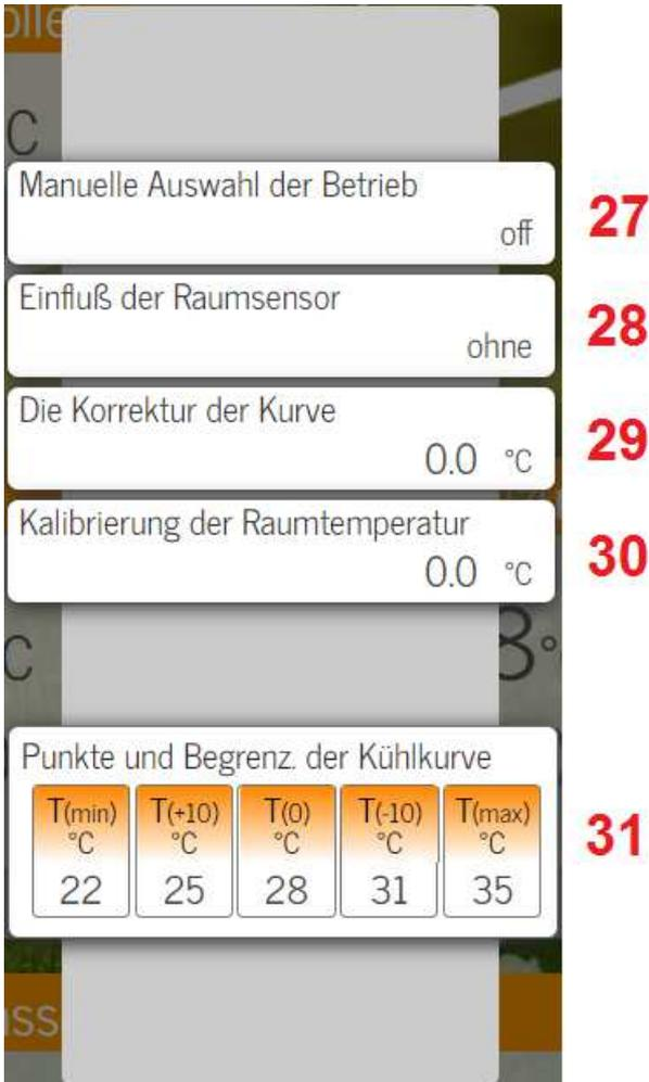
Abbildung 8: Erweitertes Fenster des Mischkreises 1/2
