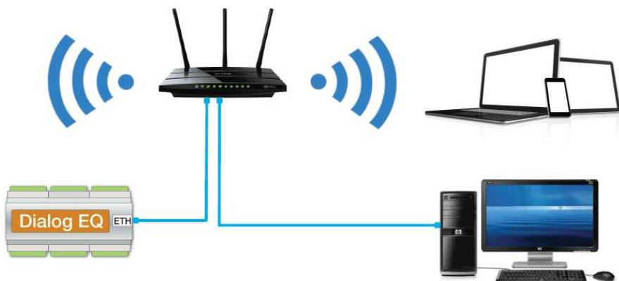
Slika 11: Povezovalna shema DEQ in računalnika direktno na router
