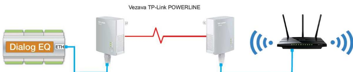
Slika 15: Vezava DEQ regulatorja z routerjem s pomočjo dveh Powerline adapterjev
