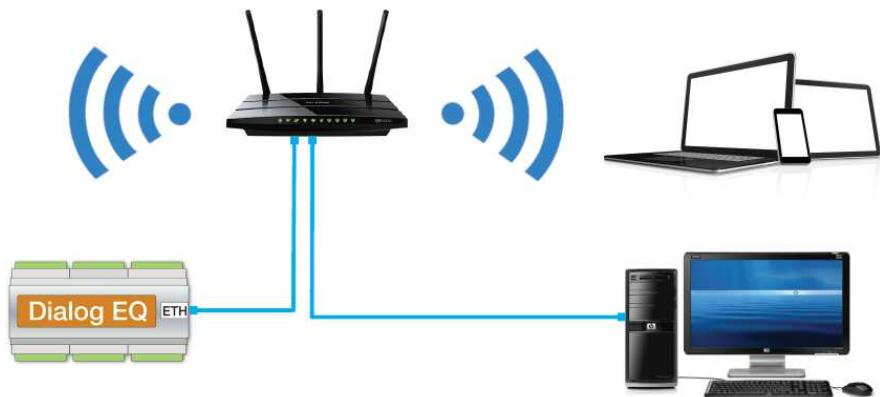
Slika 12: Povezovalna shema DEQ in računalnika direktno na router
