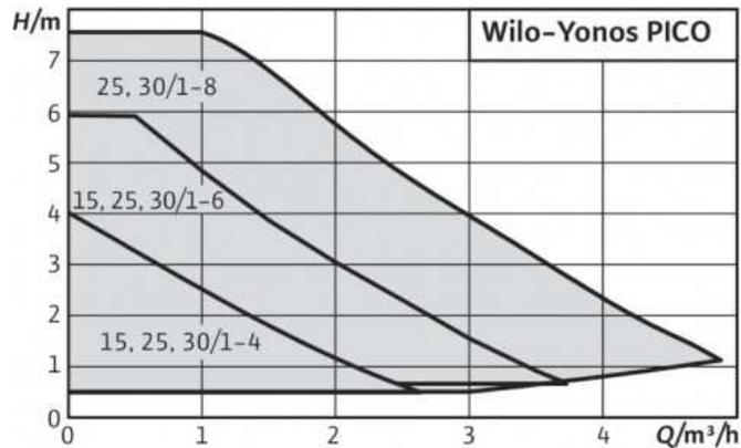
Zgornji diagrami so namenjeni pravilnemu dimenzioniranju ogrevalnega sistema. Glede na moč obtočne črpalke mora biti minimalni pretok, ki ga zahteva zunanja enota in je zabeležen v tabeli tehničnih podatkov vedno dosežen.
