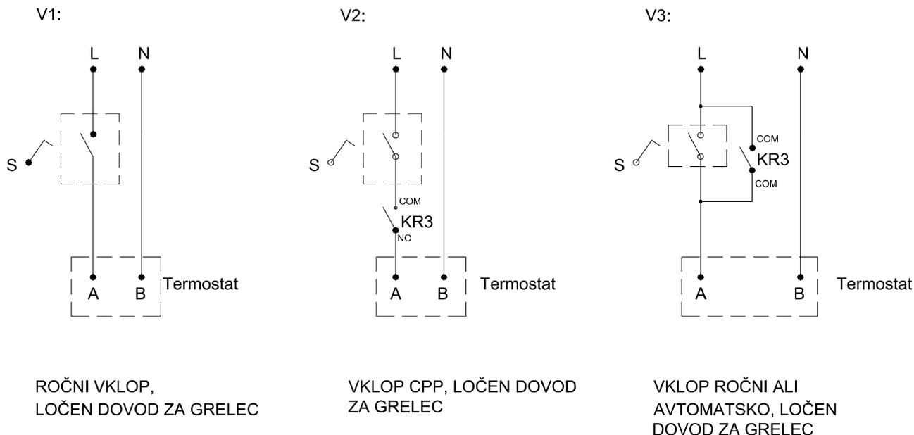
Načrt kako se izvede priklop el. Grelca za variјanto V2 in V3.
