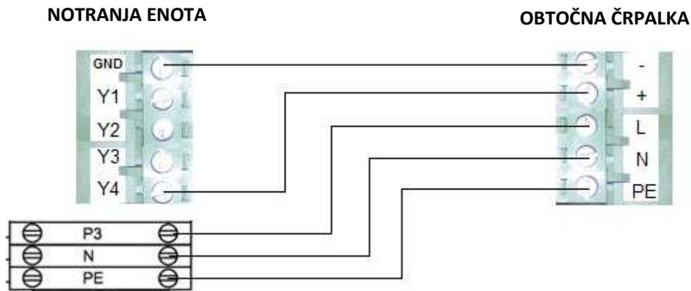
Napajanje obtočne črpalke solarnega sistema se izvede, kot je navedeno v električni shemi (priklučki P3, N, PE). Povezave med obtočno črpalko solarnega sistema in regulacijo so sledeča:
