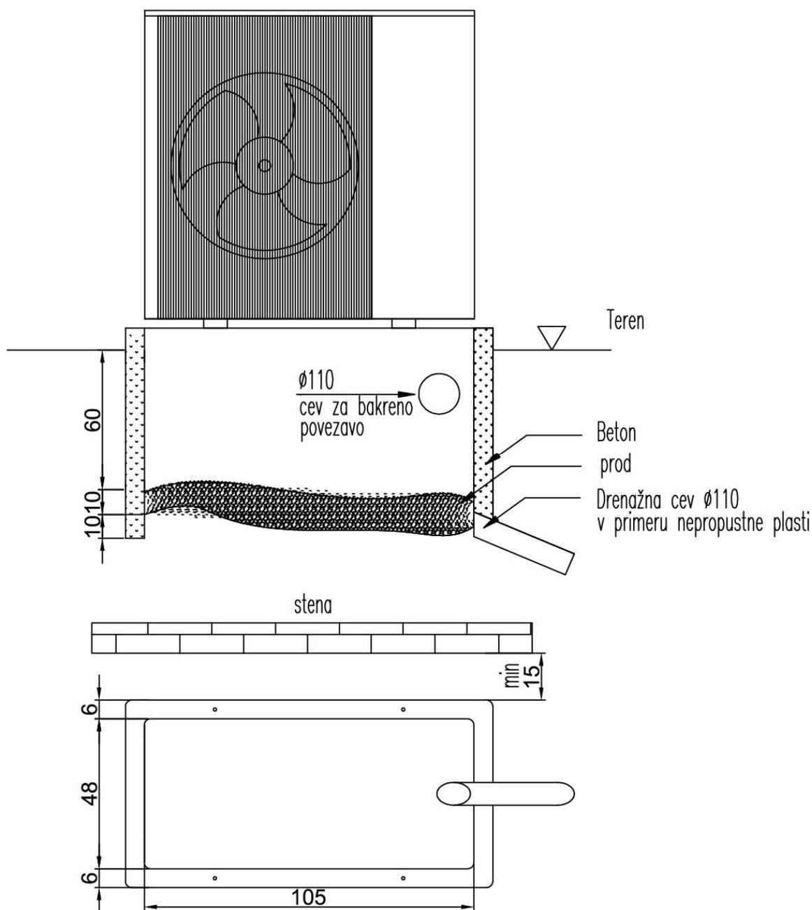
Za postavitve betonskega podstavka je potrebno izkopati luknjo globine 55cm, postaviti podstavek v izkopano luknjo, napeljati freonsko in električno povezavo ter podstavek zasuti nazaj. V kolikor na globini 50cm pridete do vodo propustne kamnine, je odtok kondenzata omogočen, v kolikor je na dnu nepropustna kamnina, je potrebno na spodnji strani narediti odvod kondenzata v kanalizacijo ali drug odvodni sistem.
